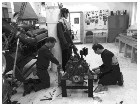
Renovering av V8. Foto: Lars Nilsson
